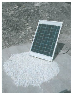
図2.試験イメージ (パネルは太陽に対して直角に設置)
